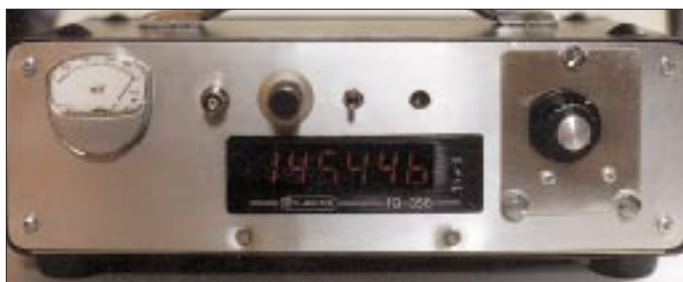
Bild 16: Das noch unbeschriftete Fertiggerät in der hier dargestellten Konzeption mit eingebautem Frequenzzähler
