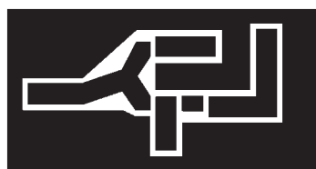
Bild 3: Trennlinien-Leitungsführung der Platine für die HF-Meßbrücke
