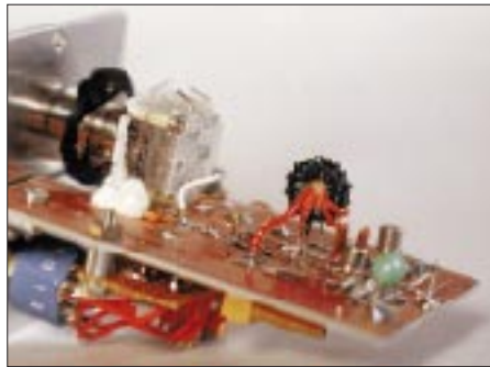
Bild 8: Detailansicht des KW-Bausteins mit HF-Transformator
