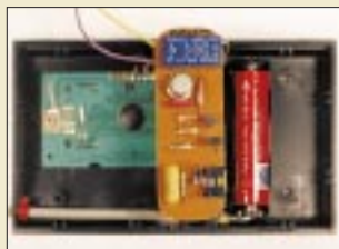
Ein Gebührenimpulszähler hilft Computer- und Modembesitzern, während sie z.B. im Internet surfen, ihre Telefonkosten im Blick zu behalten.
