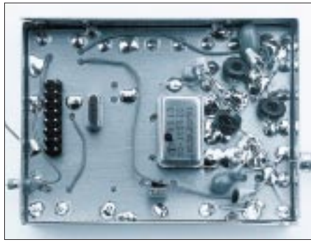
Bild 18: Auf der „Bestückungsseite“ wurden noch einige Bauelemente, insbesondere der ausgangsseitige Tiefpaß, frei verdrahtet. Fotos: DK3WX
